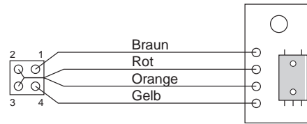
Abbildung 3.7: Rad-Encoder-Platine und Kabel. Der Photoreflektor wird auf der Oberseite der Platine montiert; auf der Unterseite befinden sich die Leiterbahnen.
